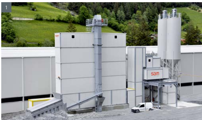
1. Beschickung Hochbunker mittels Gurtbecherwerk / Feeding of container hopper by bucket elevator ■ 2. Beschickung Hochbunker mittels Förderband / Feeding of container hopper by belt conveyor
