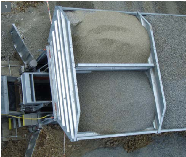
1. Teilung Bunkerammer / Division of hopper bin ■ 2. Bunkereinheit Scandi 104 L / Hopper unit Scandi 104 L
