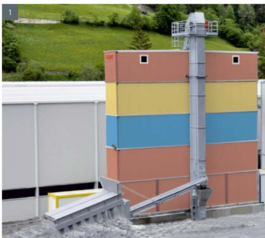
1. Beschickung Hochbunker mittels Gurtbecherwerk / Feeding of container hopper by bucket elevator ■ 2. Beschickung Hochbunker mittels Förderband / Feeding of container hopper by belt conveyor
