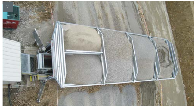
2. Teilung Bunkerammer / Division of hopper bin
